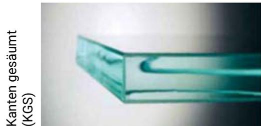
Die matt geschliffene Glaskante (Bezeichnung nach DIN 1249 Teil 11 → „KGN“) verschafft der Glaskante die höchste Festigkeit. Gegenüber der gesäumten Glaskante (Bezeichnung nach DIN 1249 Teil 11 → „KGS“) erreicht sie eine 25% höhere Festigkeit.
